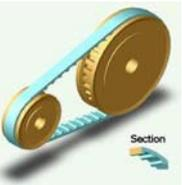
Les poulies crantées et la courroie associée assurent une transformation de mouvement sans glissement. Comme les engrenages, cette transformation de mouvement est par obstacle, donc avec conservation des positions relatives des poulies à tout instant.
