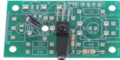
La télécommande PICAXE émet un signal infrarouge qui véhicule un code propre à chaque touche appuyée.
