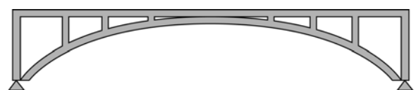
Pont en arc à tablier supérieur
