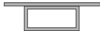
Coupe transversale d'un caisson
